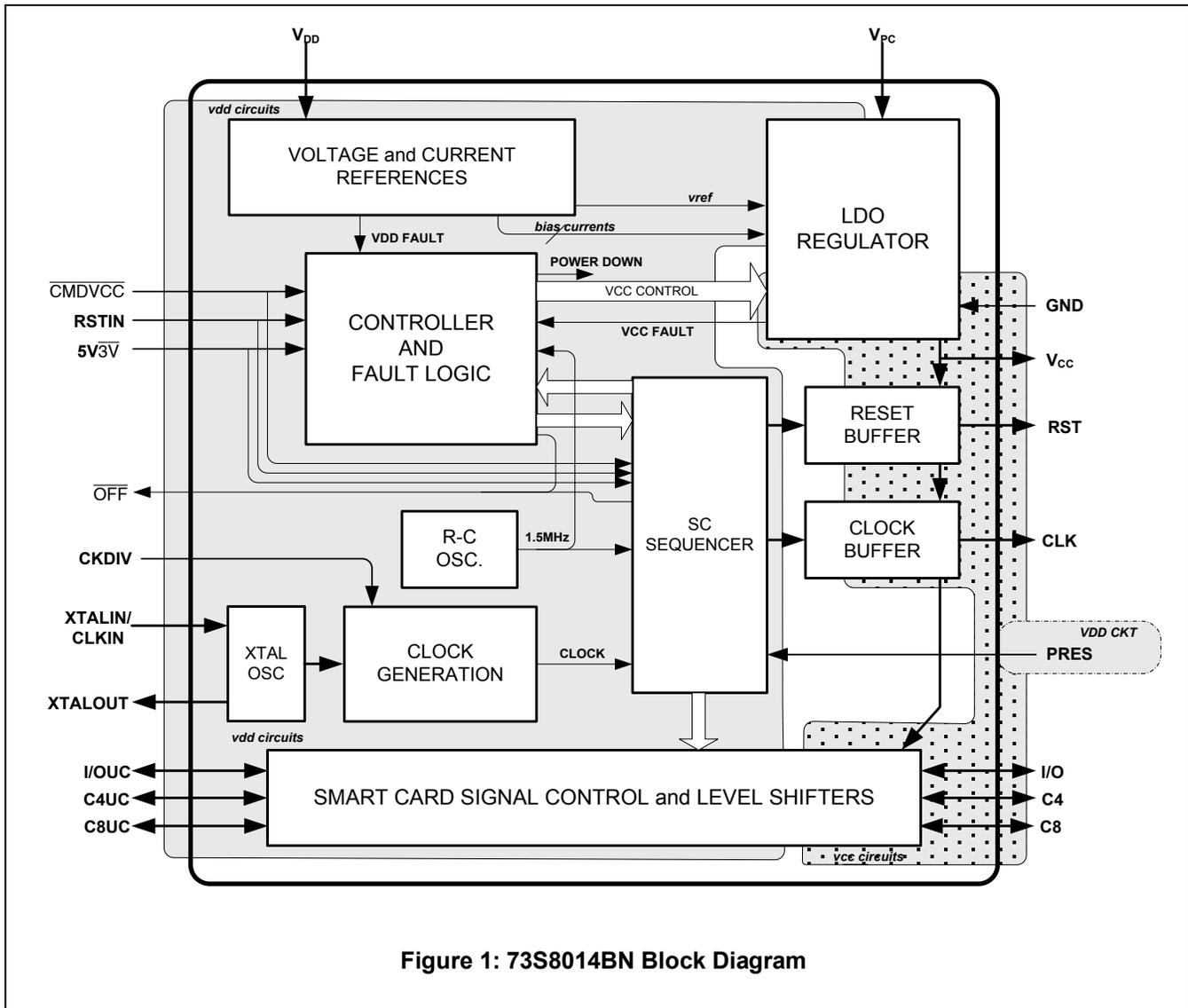
**Figure 1: 73S8014BN Block Diagram**
