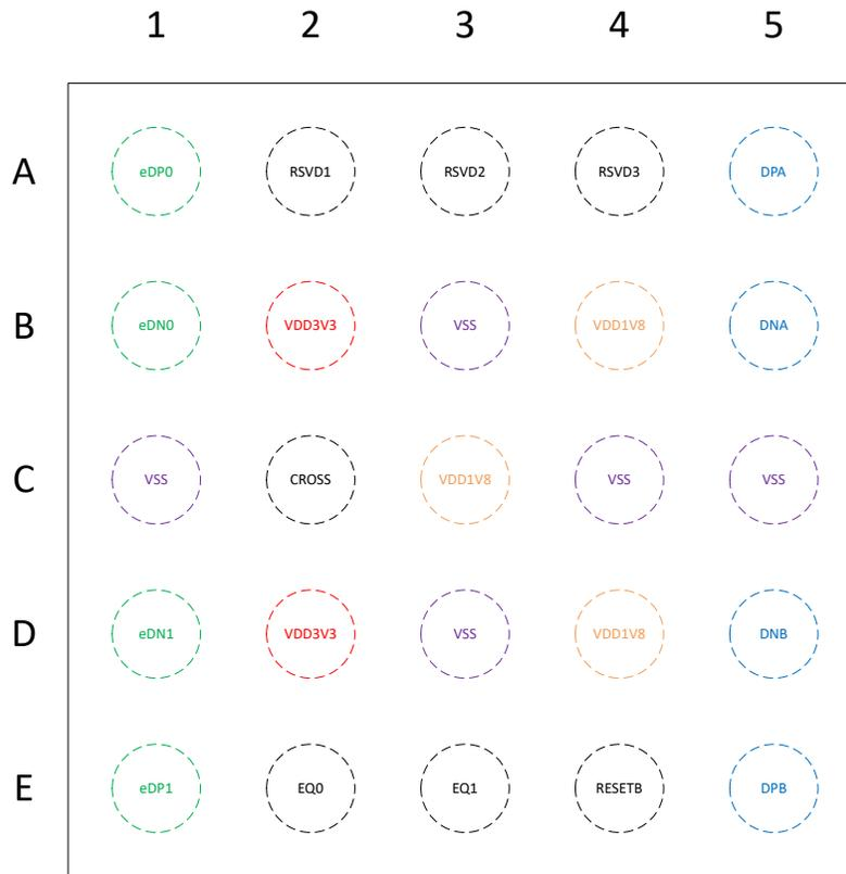
**Figure 5-1. YCG Package, 25-Pin DSBGA (Top View)**
