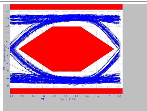
Figure 5-4. 4 Meter Post-Channel With TUSB211A-Q1 EQ=2
