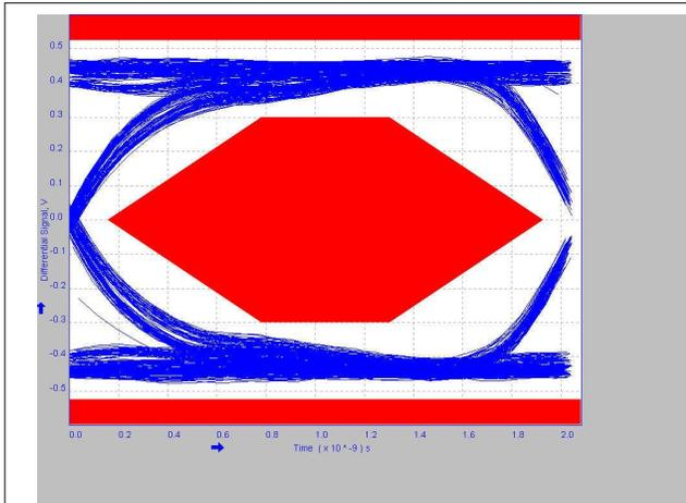
Figure 7-9. 1 Meter Post-Channel Without TUSB211A-Q1
