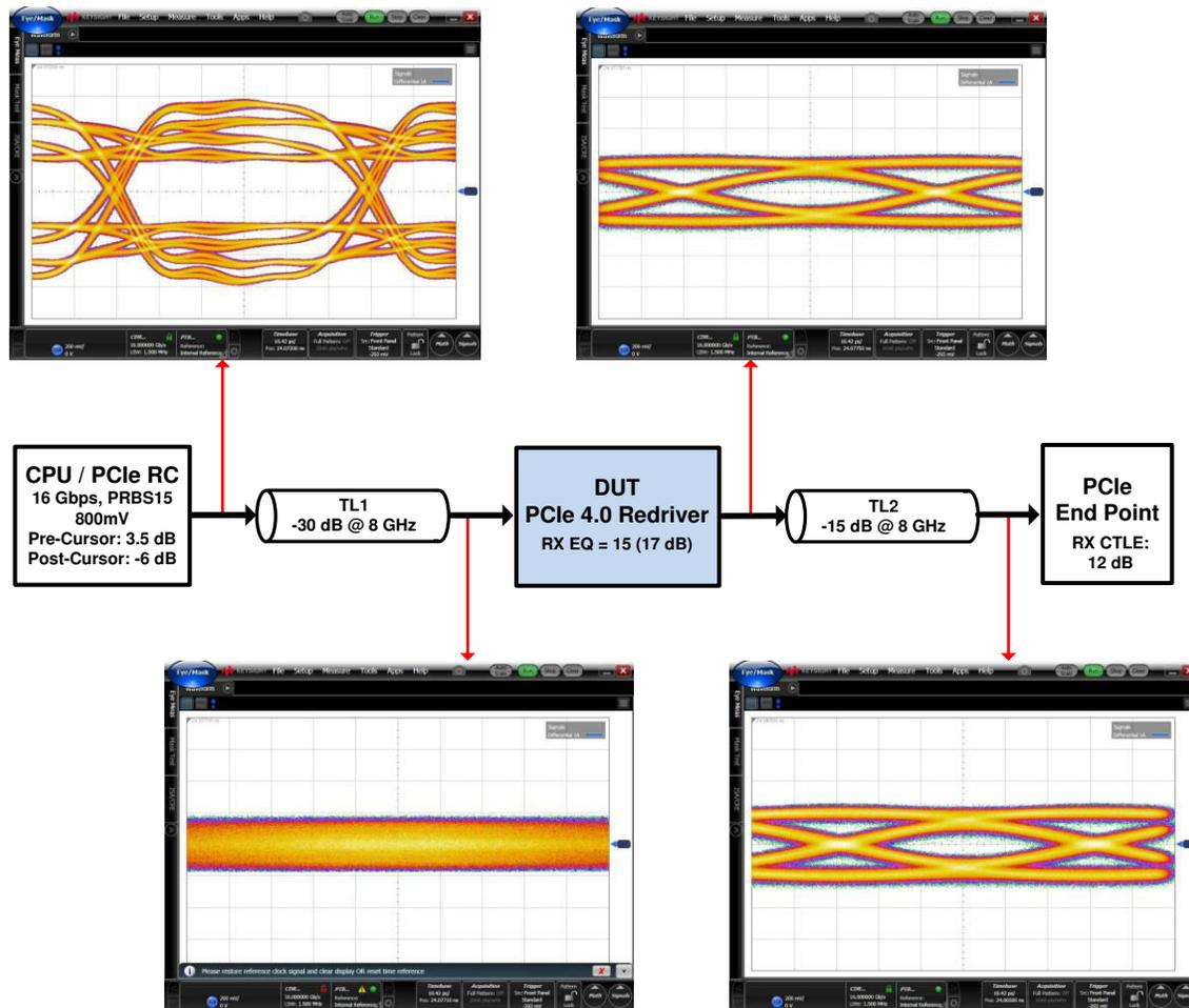
Figure 8-3. PCIe 4.0 Link Reach Extension Using the DS160PR421
