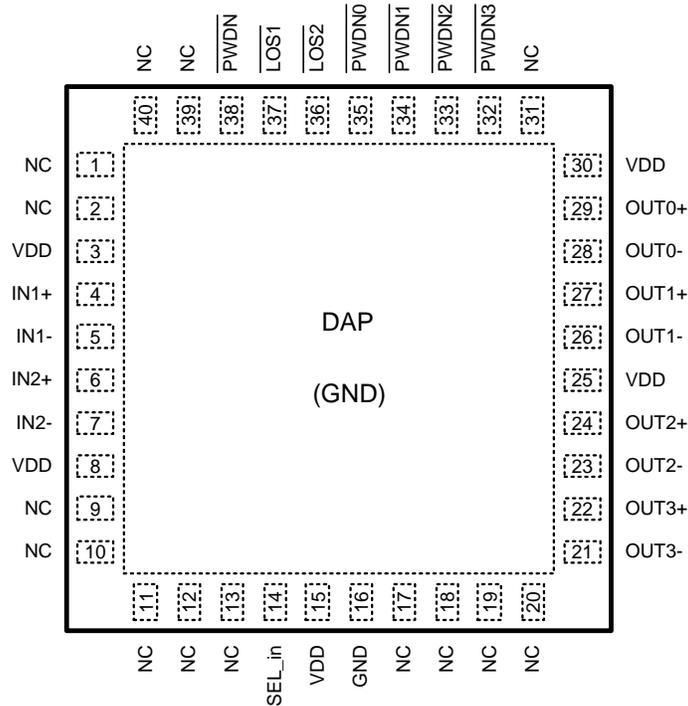
**Figure 1. DS10BR254 Pin Diagram**
