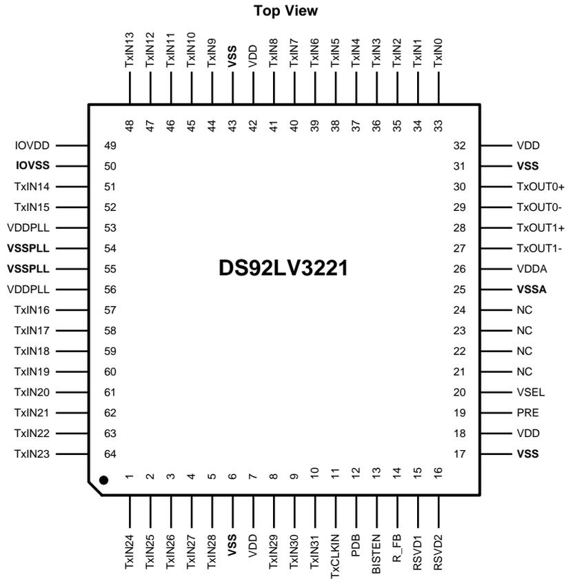
**Figure 1. DS92LV3221 Pin Diagram
