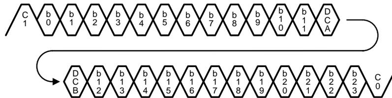
**Figure 14. FPD-Link II Serial Stream**
