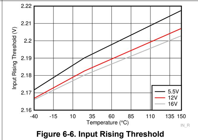
**Figure 6-6. Input Rising Threshold**
