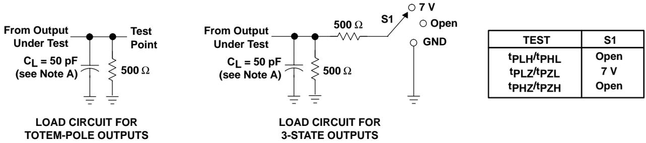
**LOAD CIRCUIT FOR TOTEM-POLE OUTPUTS**
