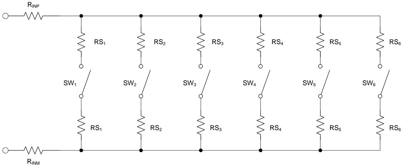
**Figure 21. Programmable Attenuator**
