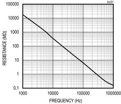
BioZ RX CHANNEL COMMON MODE INPUT RESISTANCE
