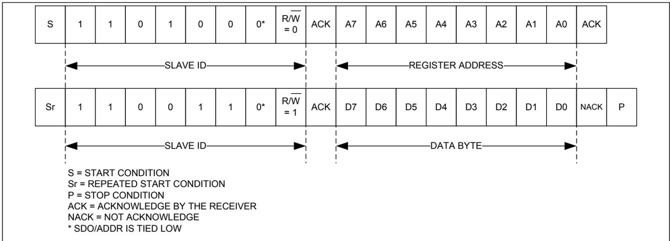
Figure 27. I<sup>2</sup>C Single-Byte Read Transaction
